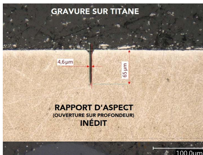
Observation en coupe transversale d'un échantillon de titane après préparation métallographique, montrant une tranchée de 4,6 \mu\text{m} de large et de 65 \mu\text{m} de profondeur gravée par plasma.
