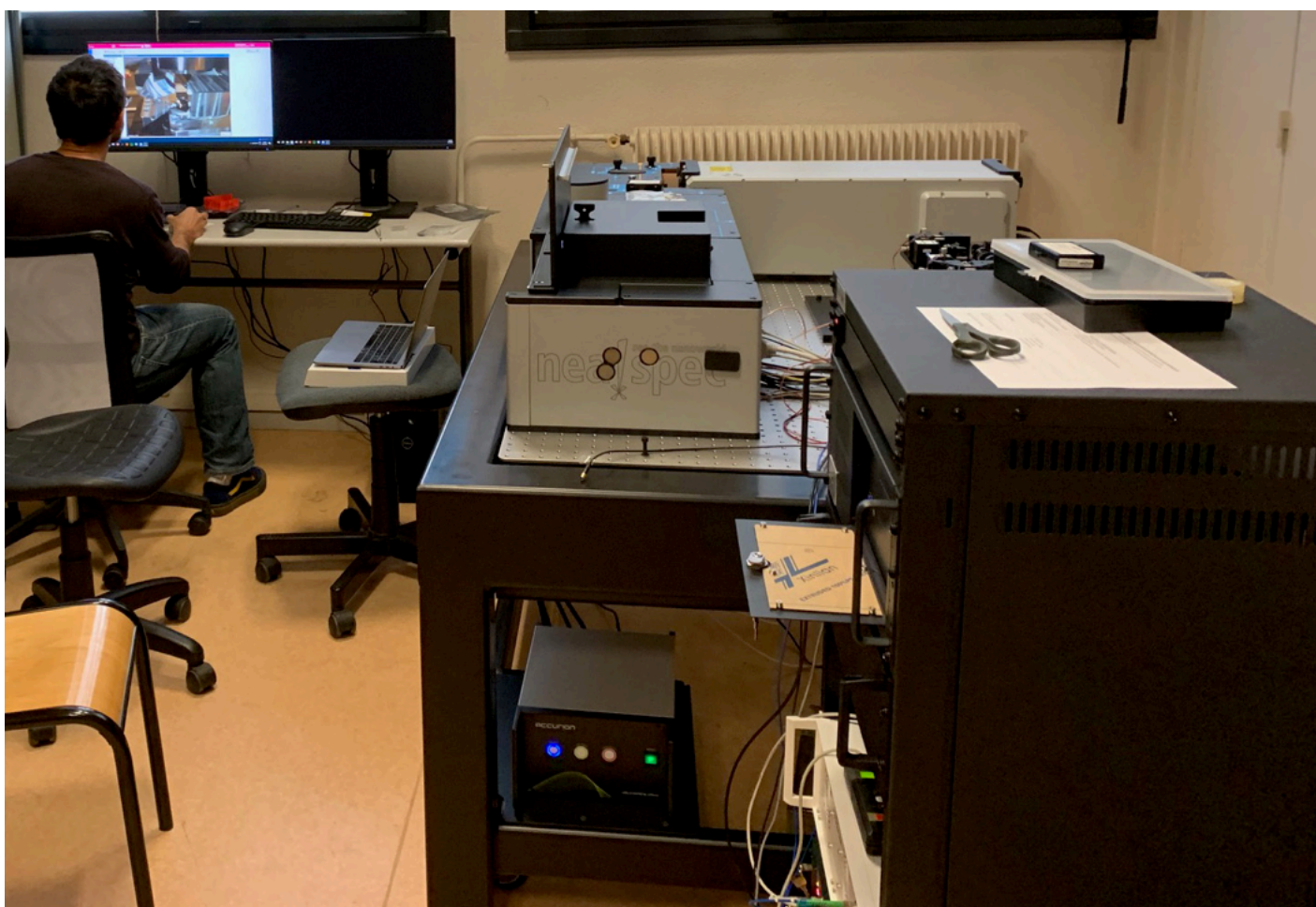
Le s-SNOM (Scattering-type Scanning Near-field Optical Microscopy) du laboratoire GREMAN à Tours, permettant d'effectuer de la microscopie optique en champ proche.
