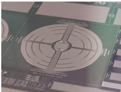
Les composants électroniques sont **fabriqués**, **implantés** sur les puces et **testés** au sein du CERTeM avant leur intégration dans des dispositifs.
